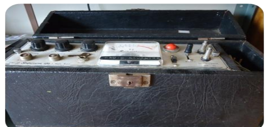
Figura 23 – Gravador utilizado pela rádio Xavantes de Ipameri em 1950 que registra o som em fios. Pesa aproximadamente de 12 quilos.
